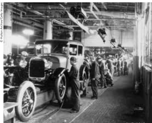
Esteiras e trilhos aéreos com peças que abasteciam as linhas de montagem nas indústrias cujo modelo adotado era o fordista.
