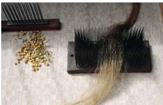
Linhaça repassada em cama de pregos para remover as cascas da palha, como parte do processo de produção de linho.
