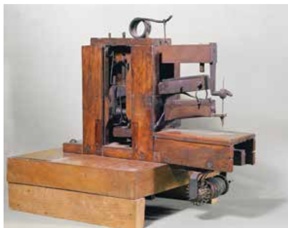
Couseuse, primeira máquina de costura em madeira e metal (1830), de Barthélemy Thimonnier e P. Clair.
