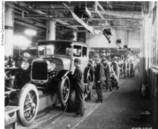
Esteiras mecânicas e trilhos aéreos com peças que abasteciam as linhas de montagem nas indústrias que adotavam o modelo fordista.
